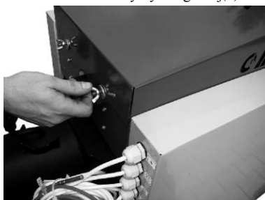
Demontaż wyczystki górnej(1)
