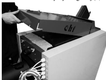
Demontaż wyczystki górnej (2)
